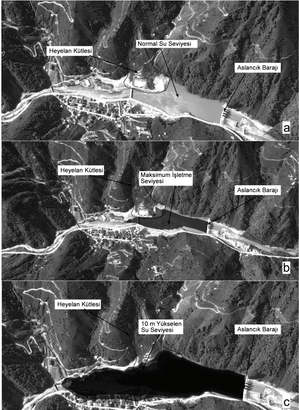
Şekil 5. Normal su seviyesi (a), Maksimum işletme seviyesindeki su seviyesi (b) Kütle hareketi sonucu 10 metre yükselen su seviyesi (c).
